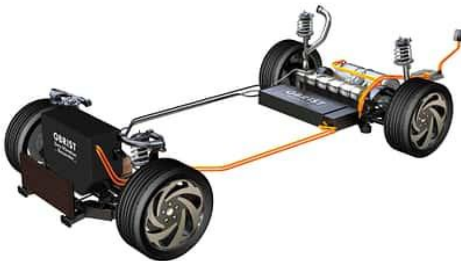
Bild 8 Prinzipbild des Testfahrzeugs; vorne der Methanolmotor (Zero Vibration Generator „ZVG“), hinten der elektrische Antrieb, davor die Batterie (Bild: Obrist GmbH)
